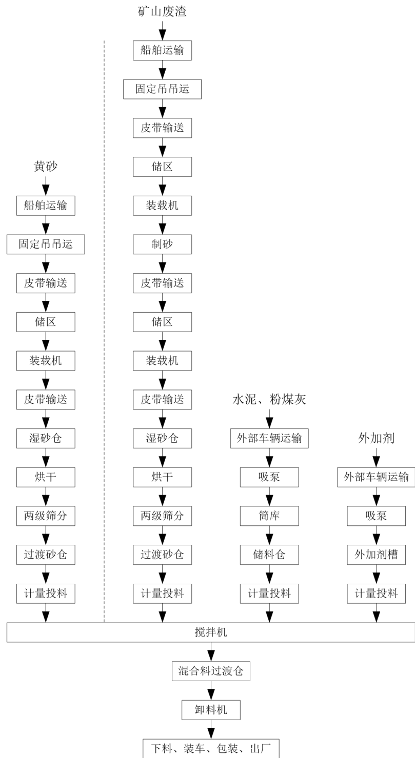
图 1-2 现有项目原报批的普通砂浆生产工艺流程示意图
