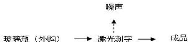
图 1-5 皂液器的生产工艺流程及产污点图
