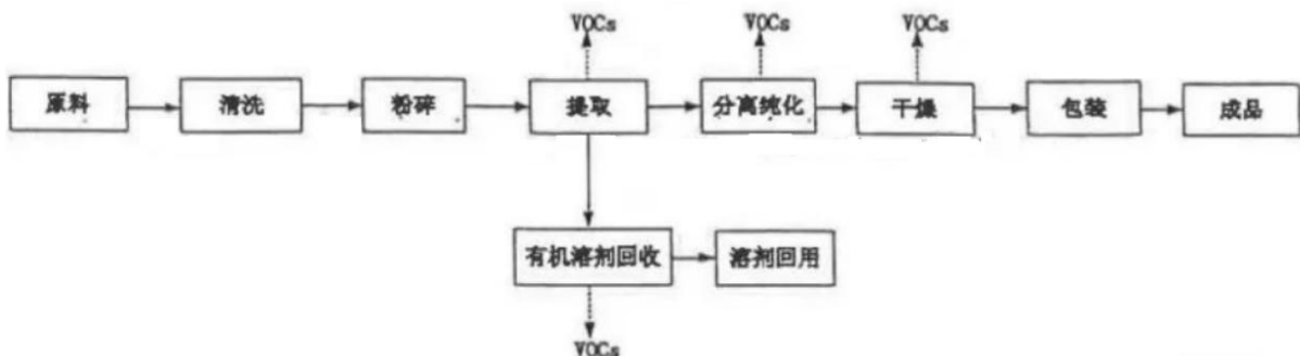
图 5.1.2 提取类制药典型生产工艺流程
