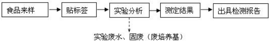
图 2-3 微生物检测运营工艺流程及产污环节
