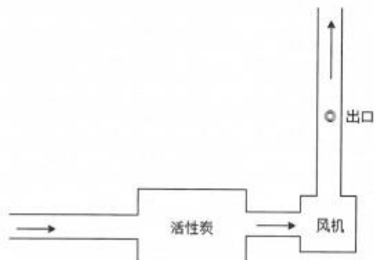
有组织废气检测流程示意图：
