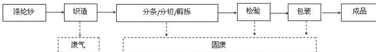
图 5-3 商标生产工艺流程及产污点图 2
