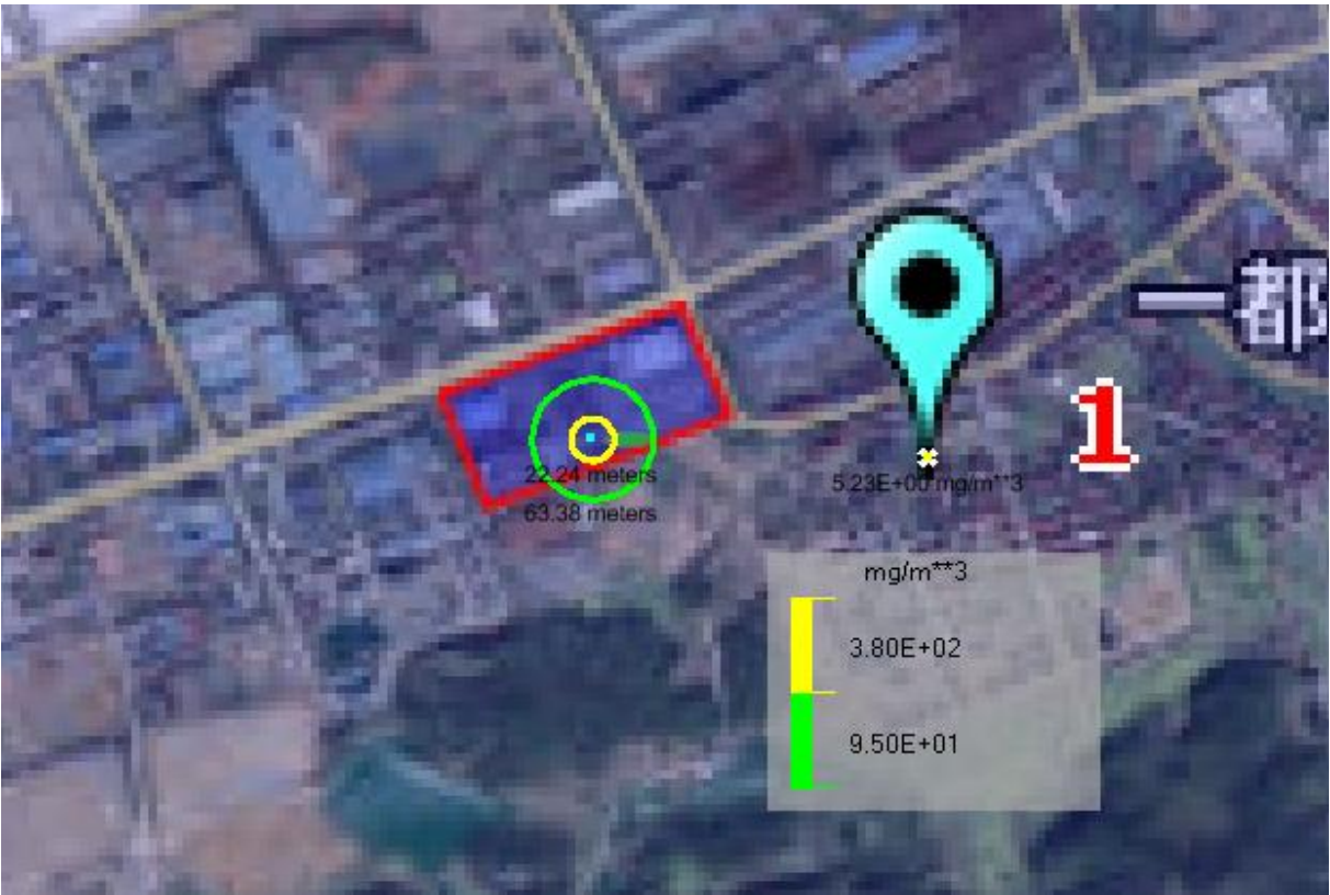
图 5.7-14 最常见气象条件下储罐泄漏火灾事故最大影响范围
