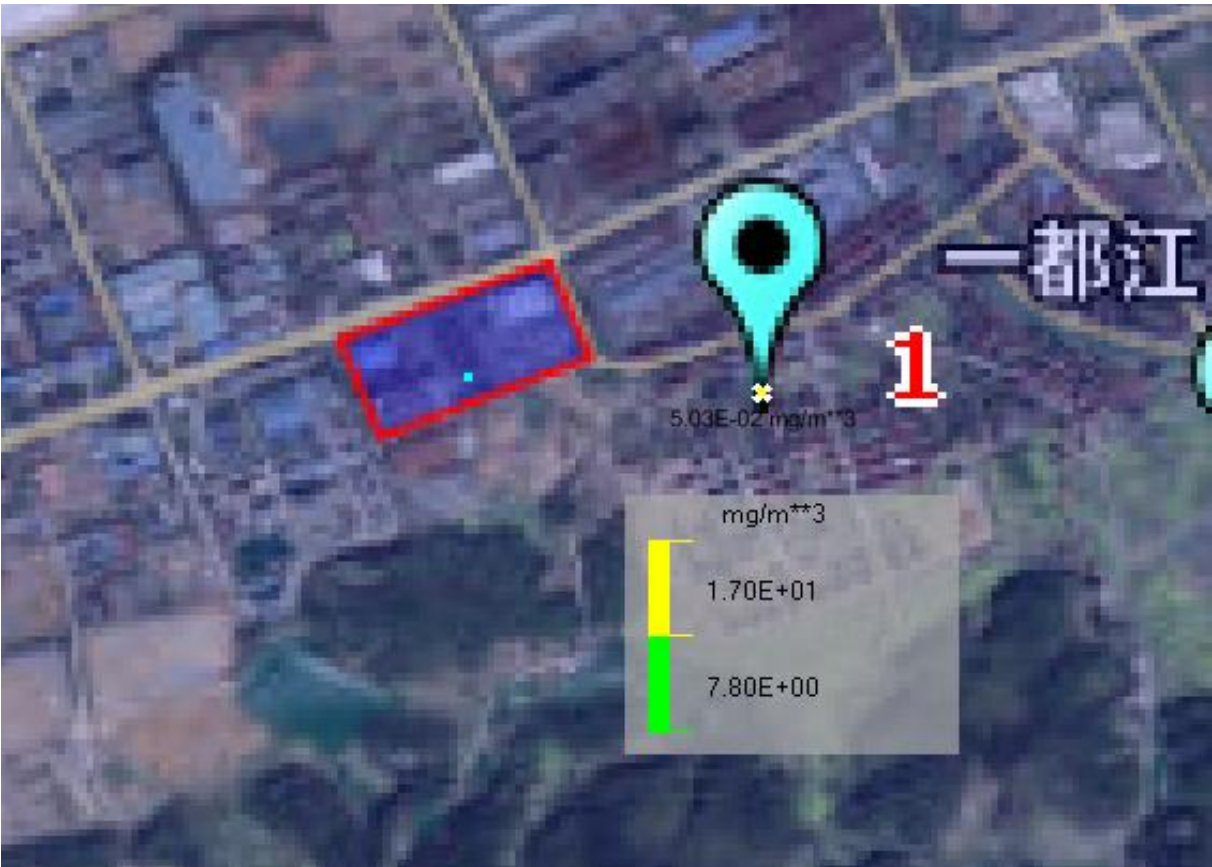
图 5.7-17 最不利气象条件下储罐泄漏火灾事故最大影响范围
