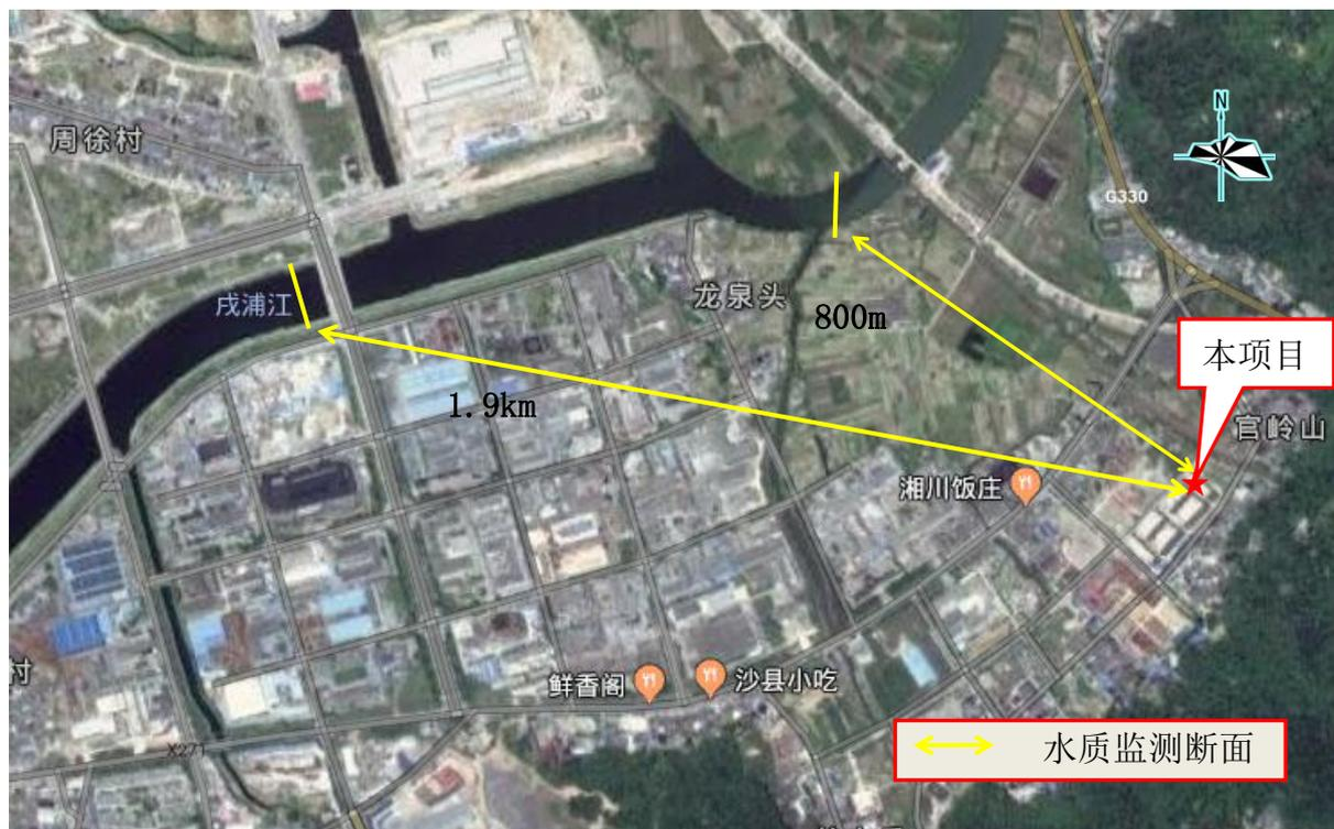
图 3-1 项目水、大气监测点位示意图
