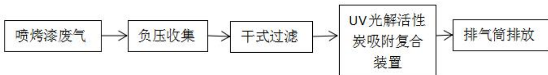
图 8-1 废气处理工艺流程图
