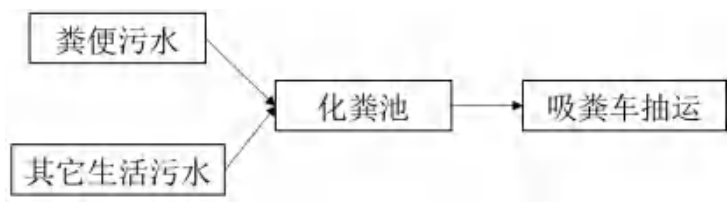
图 7.1-5 生物污水处理工艺图
