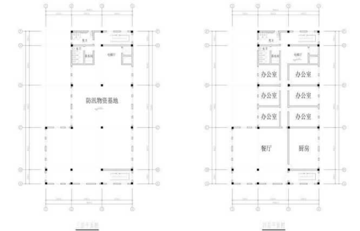
图 3.6-33 管理中心三层和四层平面布置图
