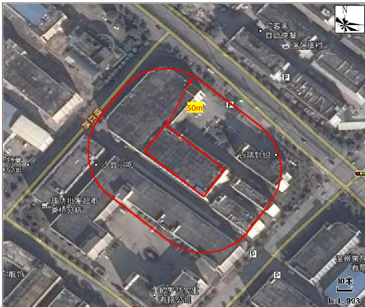
图 7-1 卫生防护距离包络线图
