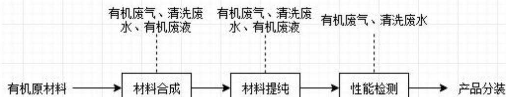
图 5-2 项目研发工艺流程及产污图
