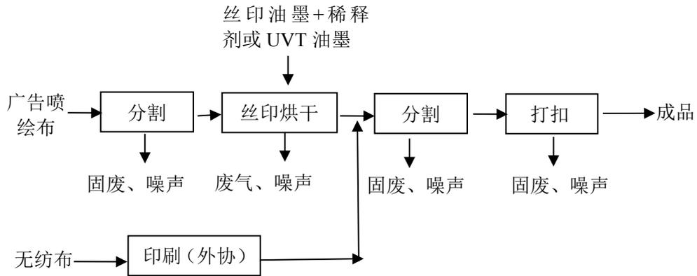
图 2-1 项目工艺流程图
