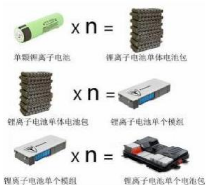
图 4.1-1 典型汽车动力锂电池包的构成示意图
