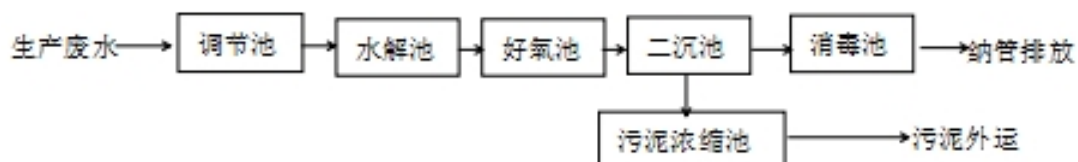
图 4-1 企业自设污水处理站废水处理工艺流程图
