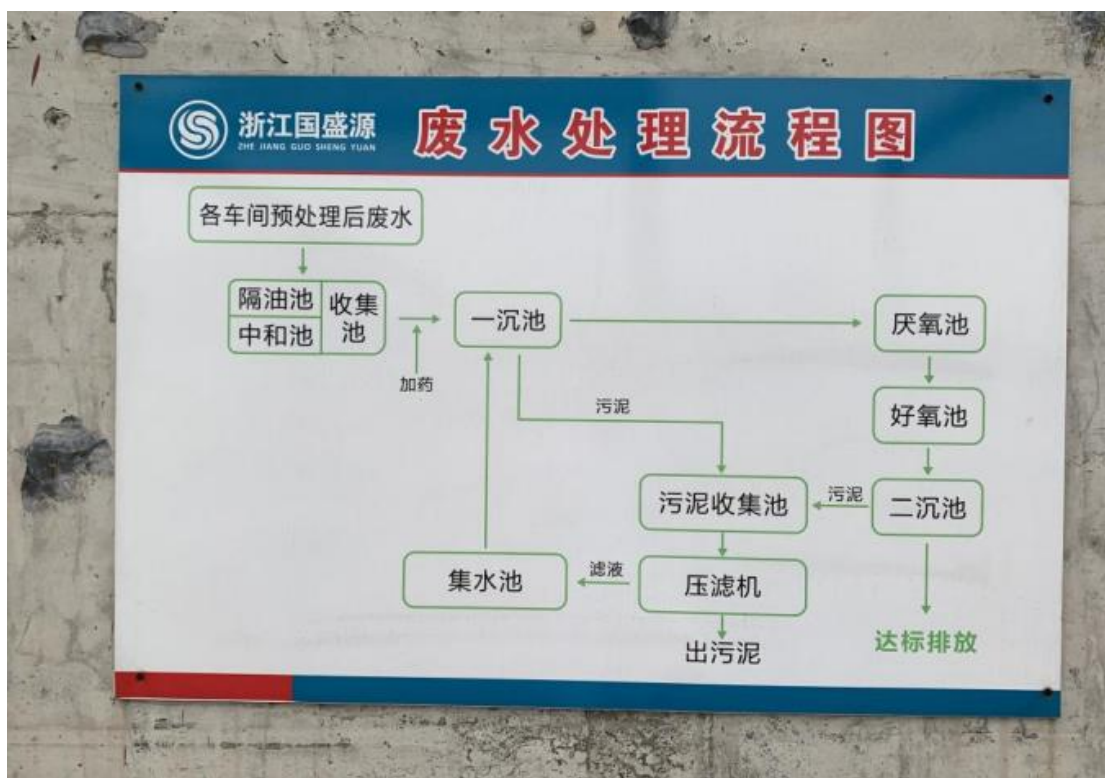
图 2-5 企业废水处理工艺流程图
