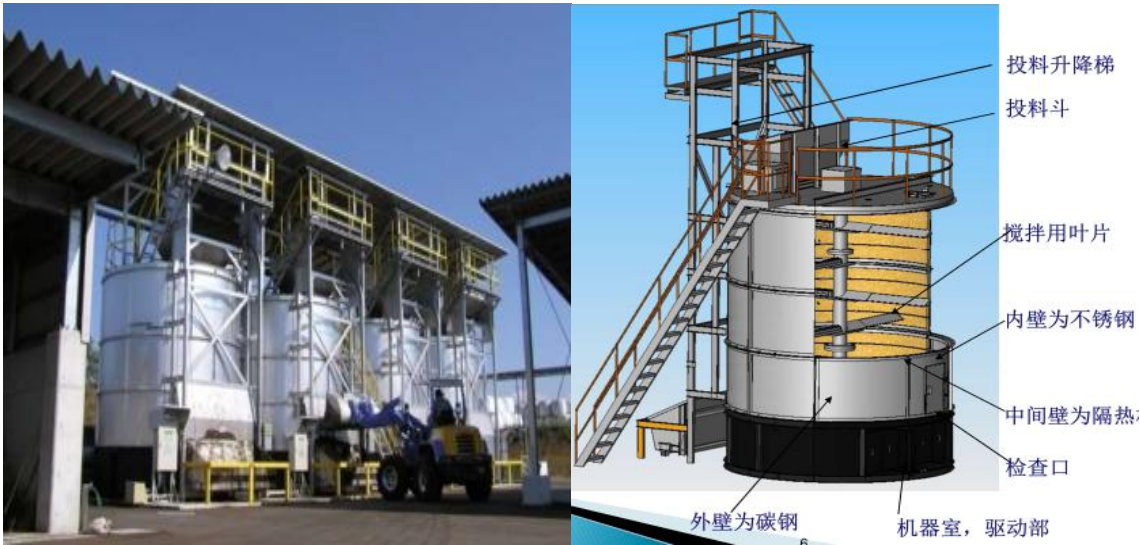
图 3.2-5 智能高温好氧发酵罐设备原理及实景图
