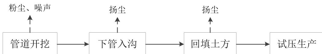
图 5-2 施工期管线铺设工艺及产污流程图
