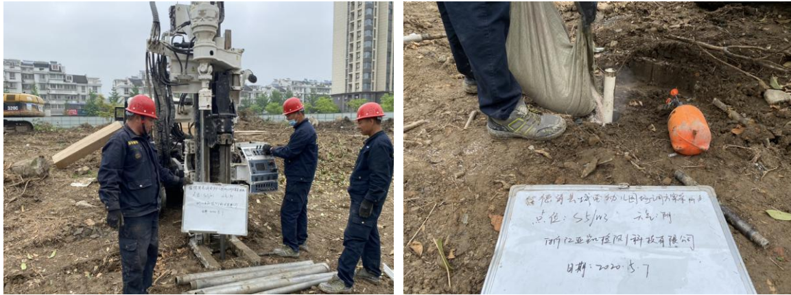
图 5-3 地下水部分现场采样照片
