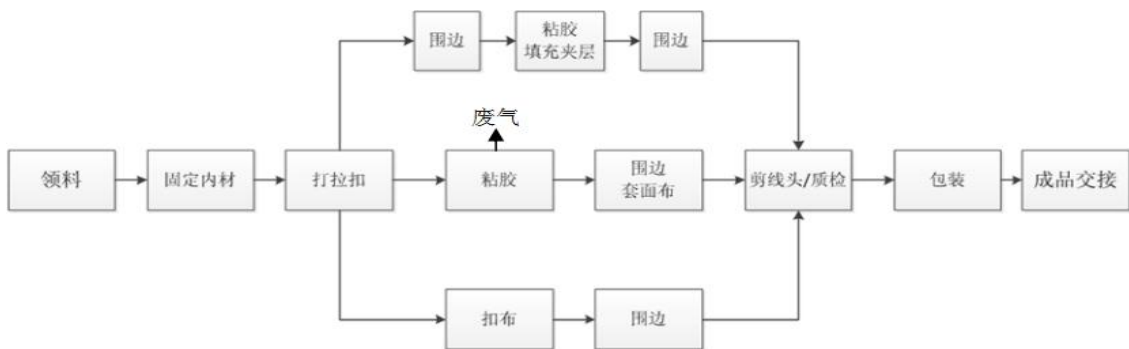
图 2-9 床垫组装工艺流程
