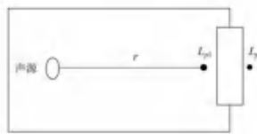
图 4-1 室内声源等效为室外声源图例
