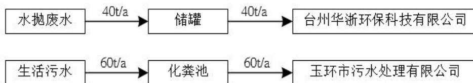
图 4-1 废水处理工艺图
